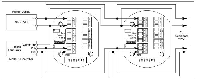
Figure 33: Alternate Modbus Wiring
